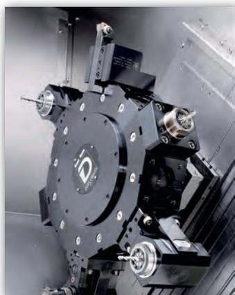
**Серия FCL-Y** Прямая конструкция с Y- осью и с роликовыми направляющими обеспечивает стабильность на тяжелых режимах резания.
